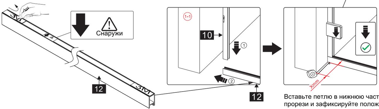
Вставьте петлю в нижнюю часть прорези и зафиксируйте положение.
