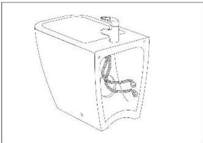
3. Установите смеситель, необходимо выполнить подключение холодной и горячей воды. **Внимание!** Не путайте трубы, соединяемые со смесителем.
