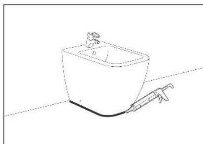
9. После проведения теста на смыв, обработайте основание биде герметиком.
