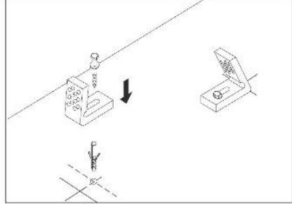
2. Просверлите отверстие в полу и зафиксируйте крепёжные уголки с помощью дюбелей.
