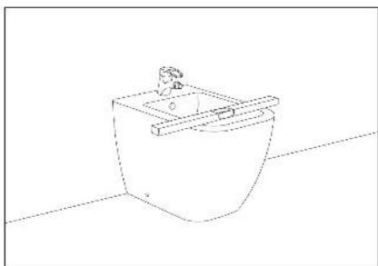
8. Включите воду и выполните проверку соединений на предмет протекания. Выровняйте биде с помощью уровня.
