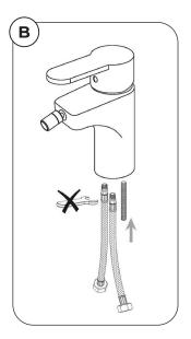
2. Прикрепите винт-шпильку и гибкую подводку для воды к смесителю (рис. В).
