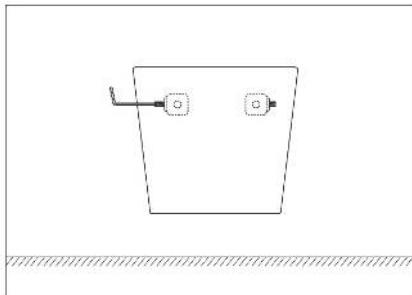
5. Затяните винты и зафиксируйте биде.
